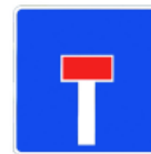
S-15a Preseñalización de calzada sin salida
